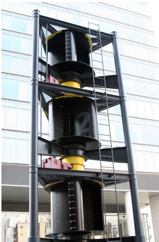
Figura 6 Generatore eolico di Savonius. Anche questo generatore, come tutti quelli ad asse verticale, non risente della direzione di provenienza del vento. Ha dei rendimenti mediamente più bassi dei generatori di Darrieus o a pale, ma si attiva con velocità minori del vento.
