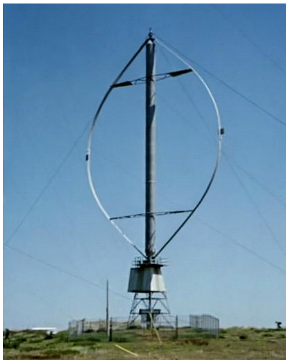
Figura 5 Generatore eolico ad asse verticale di Darrieus. Questo tipo di generatore non deve disporre di meccanismi per orientarsi lungo la linea di flusso del vento, ma presenta altre peculiarità che rendono la sua installazione più problematica di quella dei generatori ad asse orizzontale.
