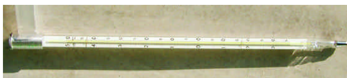
Termometro di precisione a mercurio (proprietà Furio Pieri)
