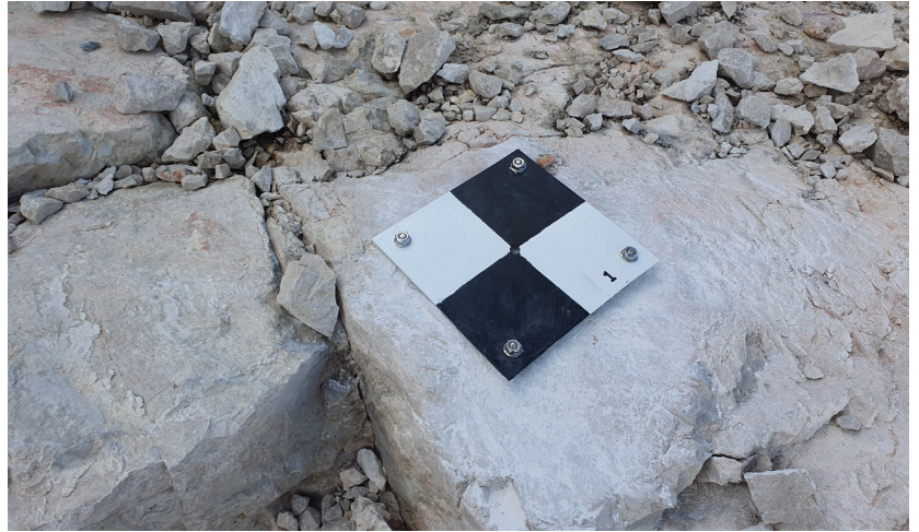
Figure 2 - New permanent reference points were installed around the ice mass. Figura 2 - Nuovo punto di controllo permanente installato in vicinanza del glacionevato.
